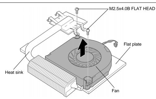
Figure 4-32 Removing the fan
